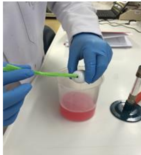
図 2 : SMOD の中管をパイプクリーナーなどのブラシで洗います (写真はシェニールワイヤーステム)。
